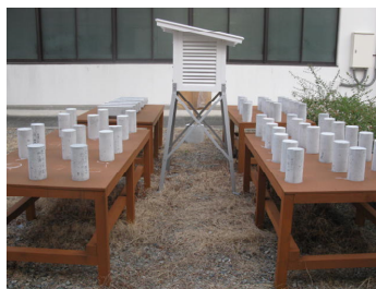
図-1 長期屋外暴露試験
