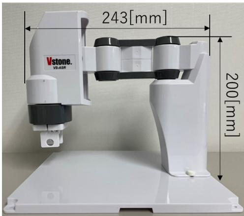
Fig. 2: SCARA robot
