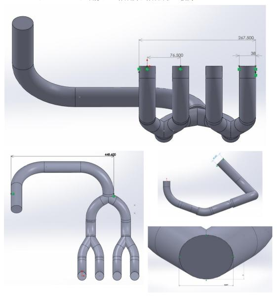
エキゾーストマニホールドの全体像を CAD で作成しました。(上図参照) 概要としては、4-2-1形状であり、管をつなげていくごとにパイプ径が $\Phi$ 38 $\Rightarrow$  $\Phi$ 42.7  $\Rightarrow$  $\Phi$ 48.6 と太くなるようにしていった。パイプを太くしていった理由は、パイプをテーパー部で切断し溶接すると、溶接部の口が楕円(長辺がパイプの径より大きい)状となり、それを覆うために大きめのパイプが必要であったからです。(溶接部の口の図参照) 曲げ R は、 $\Phi$ 38 と $\Phi$ 42.7 のパイプは R100、 $\Phi$ 48.6 のパイプは R120 となっている。 しかし、全高が高く、フレームの底面を突き抜ける構造となってしまったため、管を繋ぐ間隔をより狭めるなど形状の再検討を行い作成に入る予定です。 現在、作成方法は以下のものを考えています。
