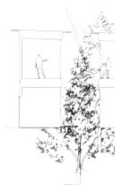
平面計画の際、二つの建物の交わる角度などを等高線に従いながらスタディを繰り返したが、断面計画にも山の地形を生かすことを考えた。北側の棟は基本的に一般市民が多く利用すると予想される。ギャラリー、店舗間は下の地形が唯一下がっている部分であったため、建物のレベルもスロープを用いて下げ、断面計画に変化を加えた。ギャラリー側のスロープの上部は吹き抜けとなっており、他の場所と変わった雰囲気を感じることができる。
