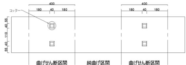
図 2 試験体 HPC-4 のコッター配置図
