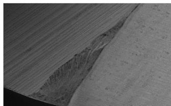
【湿式加工】: エンドミル刃先に熱衝撃による欠けが発生
