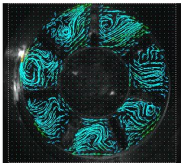
回転流路内部だけの速度算出が容易
