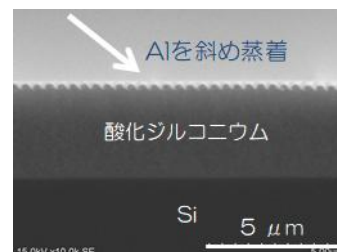
図2 作製したワイヤグリッド偏光子。
