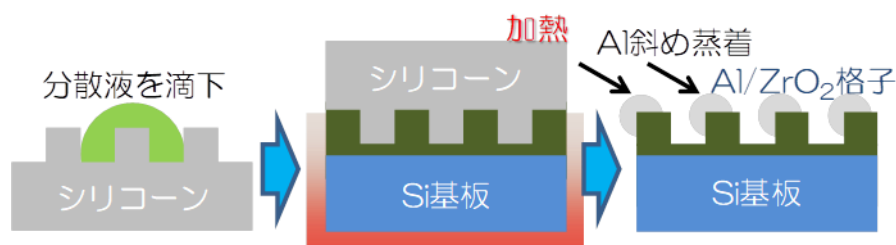
図1 ゾル-ゲル法、インプリント法、真空蒸着法による赤外用ワイヤグリッド偏光子の作製プロセス。
