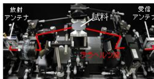
図2 テラヘルツ・エリプソメトリー光学系
