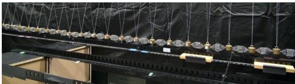
39個の振動子と40本のばねからなる連成振動子列実験装置
