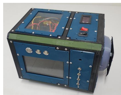
ビデオカメラを用いた粉じん濃度検出装置
