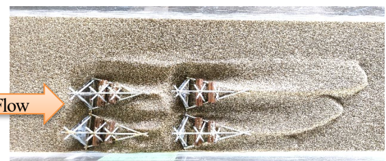
実験室における改良型水制群周辺の地形変動
