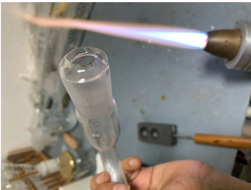
カーボンコテでガラス管直径を縮める
