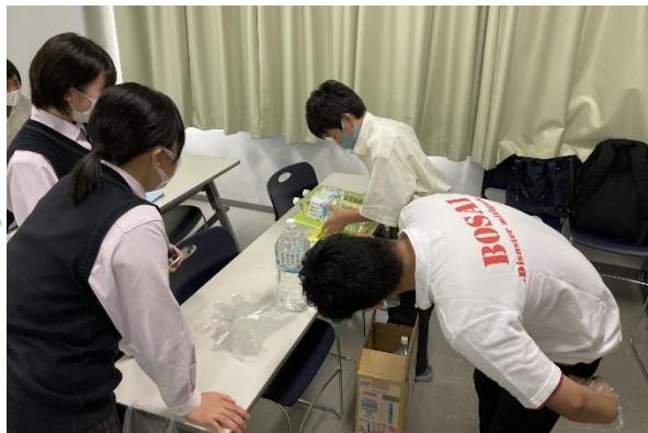
ペットボトルで荷重をかけ、作った模型の強さを確認します。今回の最高記録は8本(16kg)でした！
