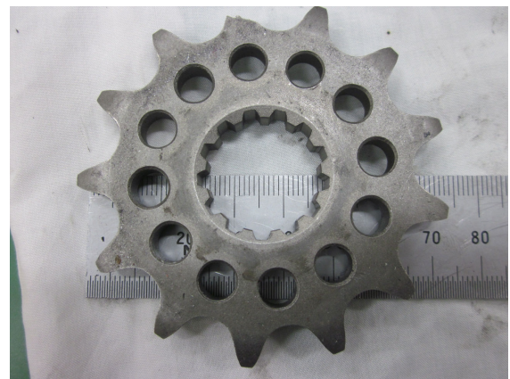
破損していたスプロケット
