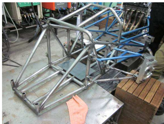
図2 フロントバルクヘッド切断後のフレーム
