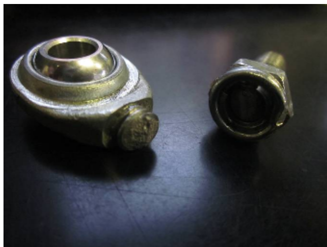
図2 破断したロッドエンド
