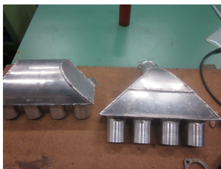
図9 サージタンク
