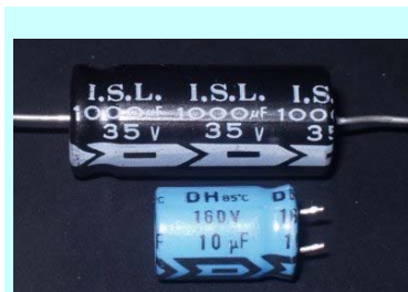
電解コンデンサ：電極表面に化学処理することで絶縁体あるいは半導体の薄膜を形成し、これを誘電体としたもの
